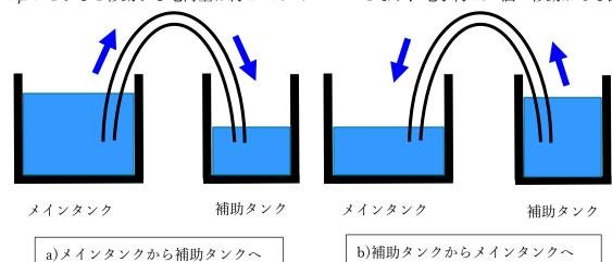
なります。例えば鉄 1g 中の原子の数は 10<sup>22</sup>個ですので、1 兆個の原子の内 1 個の原子から 1 個ずつ電子が放出される計算です。)一方、電位の変動は、マイナスの電荷つまり電子が多いか足りないかによって生じますので、アース電位が負に変動したら余分な電子を吸収し、プラスに変位したら電子を供給して変動を抑える作業をさせるわけです。貯水タンクと同じようなものです。そういった意味では、下の図のようなサイホンを考えると分かり易いでしょう。サイホンは、メインタンクと補助タンクで構成され、二つのタンクは水で充たされたチューブでつながっています。水を電子と見なしますと、左の a)の図のように、補助タンクに対してメインタンクの水面が高くなる(電子が増えて電位が低くなる)と補助タンクに水(電子)が移され、逆に低くなる(電子が減って電位が高くなる)と補助タンクから水(電子)が流れ込み、水面の高さを同じに保ちます。つまり、水位(アース電位)の変動幅を押さえる訳です。
