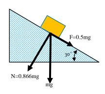
物体に生じる斜面に平行な力(滑り落ちようとする
