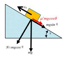
秒後に  $\alpha$   $T=v_0$  となり、物体が静止するとする。この T 秒が静止するまでにかかる時間で、その間の移動距離は  $D=\alpha$  T2/2 となる。よって、 $D=v_0^2/2$   $\alpha=v_0^2/2$   $(\sin\theta+\mu'\cos\theta)$  g となる。物体に働く斜面下向きの力は  $mg\sin\theta$  であり、静止時の最大摩擦力は  $\mu$   $mg\cos\theta$  であるので、 $\mu$   $mg\cos\theta$  である必要がある。したがって、 $\mu$   $mg\cos\theta$  となる。
